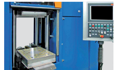
M-TECS 240 mágneses rögzítő rendszerek gumi- és műanyag ipar számára 240 °C-ig
