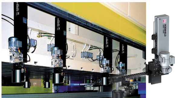
Elektromos szorítórendszerek betoló egységgel kétállomásos prés gépben
