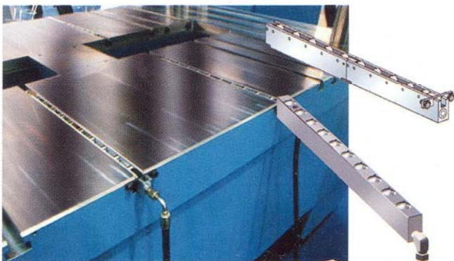
15 Sajtolóasztalba süllyesztett hidraulikus emelésű görgős lécek.
