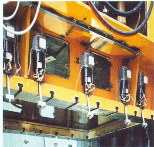
8 Kétállványos sajtoló elektromechanikus billenőkaros elemei.
